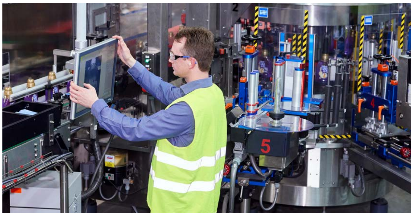
Ein Mitarbeiter kontrolliert die Etikettierkamera in der Waschmittelproduktion. (Henkel AG)
